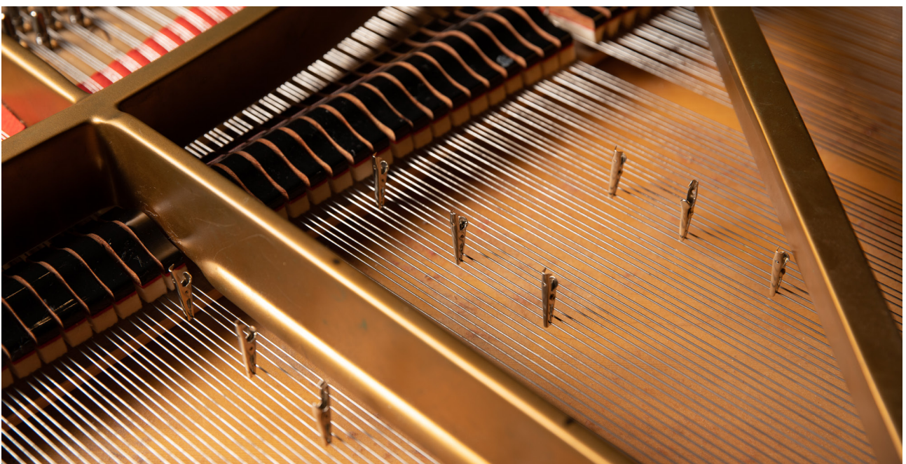
Il. 13. Umiejscowienie krokodylków na strunach fortepianu | Fig. 13. Placement of the crocodile clips on the piano strings
